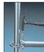
Et resultat af uovertruffet designarbejde. Der kan i samme plan monteres op til 8 komponenter i den konstruktionsmæssigt ideelle Allround roset (tilkoblingspunkt) i forskellige vinkler. Alle Allround søjler er som standard konstrueret med tilkoblingspunkter for hver 50 cm i højden. Rosetternes flade form forhindrer tilstopning med skidt af enhver art.
