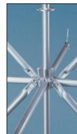
**Gennemtænkt teknologi til sammenkobling:** Rosettens 4 små udstansede huller gør, at horisontalrør automatisk centrerer i rette vinkler – de 4 store huller tillader, at tilpasningen kan ske i den ønskede vinkel.
